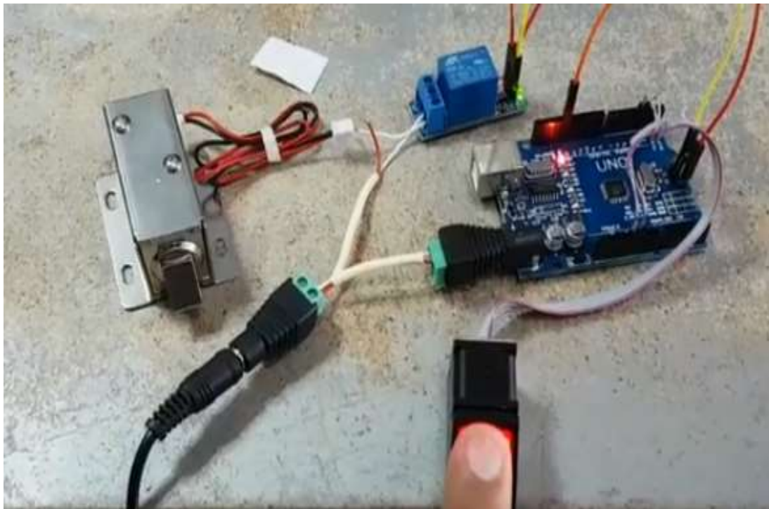
Figura 2: Conexión de cerradura magnética. Fuente: Autores, 2019.
